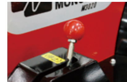
補助ブレーキレバー(停車時の安全ブレーキ)
